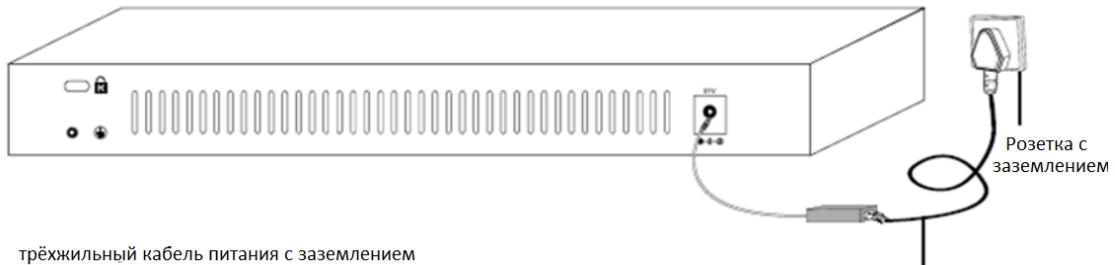
Рисунок 2.9 Заземление с использованием трехжильного кабеля питания
