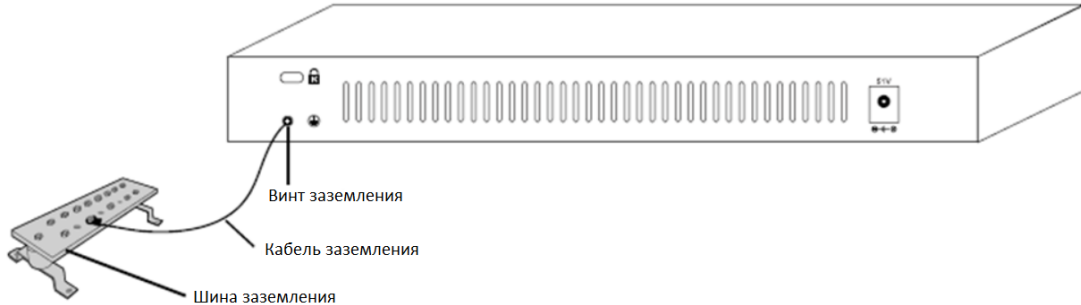
Рисунок 2.8 Подключение шины заземления
